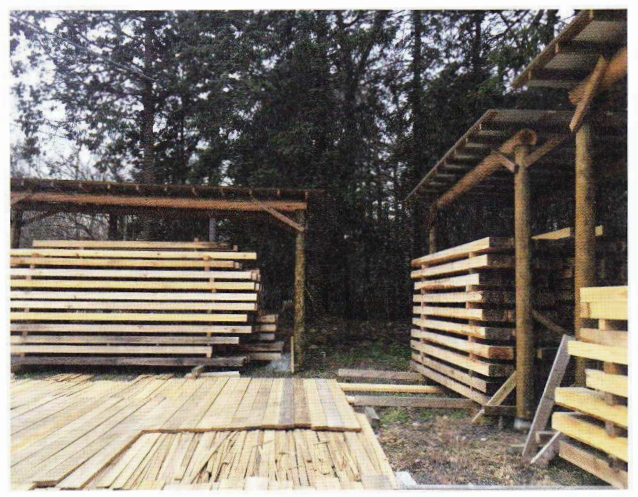
天然乾燥材のストックヤード、この状態で1年以上乾燥させます
